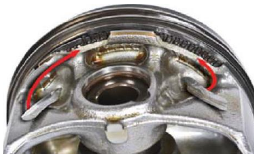
Příklad poškození pístu v důsledku LSPI pozorované při testování konkurenčního motorového oleje. Červené šipky označují části prstence pístu, které se od pístu oddělily.
